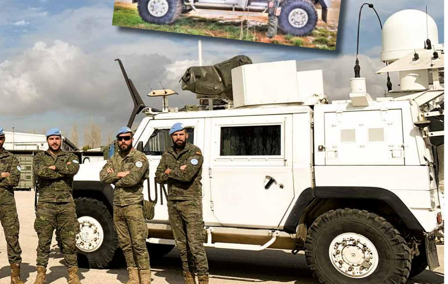
de información y seguimiento GPS radio y un equipo de radio y satélite en movimiento (estación vehicular SORIA), el cual engloba todas las distintas formas de transmisión en un vehículo que actúa como puesto de mando móvil en cualquier situación y terreno.
